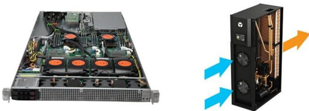
Figura 10. GPU con refrigeración líquida directa al chip de Supermicro (izquierda) y unidad de refrigeración Liebert XDU de Vertiv Group con intercambiador de calor líquido-aire (derecha)
