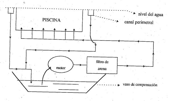
Si el vaso de compensación detecta que hay un descenso de nivel (si el agua de la piscina no llega a los canales perimetrales) entonces capta agua de la red y suple con agua nueva la carencia.
