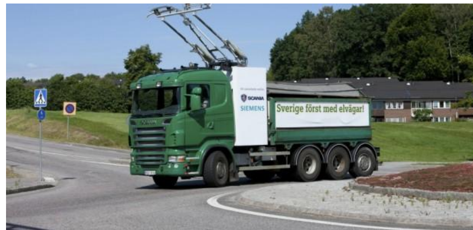
Figura 5. Camión electrificado para su uso en eHighways (Fuente: http://www.noticiaspositivas.net )
