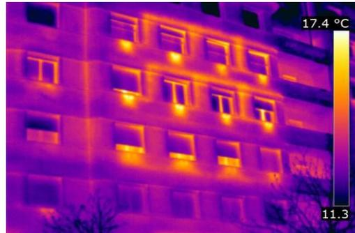
Los reflectores son unas láminas aislantes, las cuales tienen una superficie reflectora que se colocan entre el radiador y la pared, para evitar que el calor se pierda hacia el exterior, y se refleje hacia el interior de la vivienda, mejorando el rendimiento hasta un 30%.
