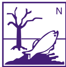
Sustancias peligrosas para el medio ambiente
